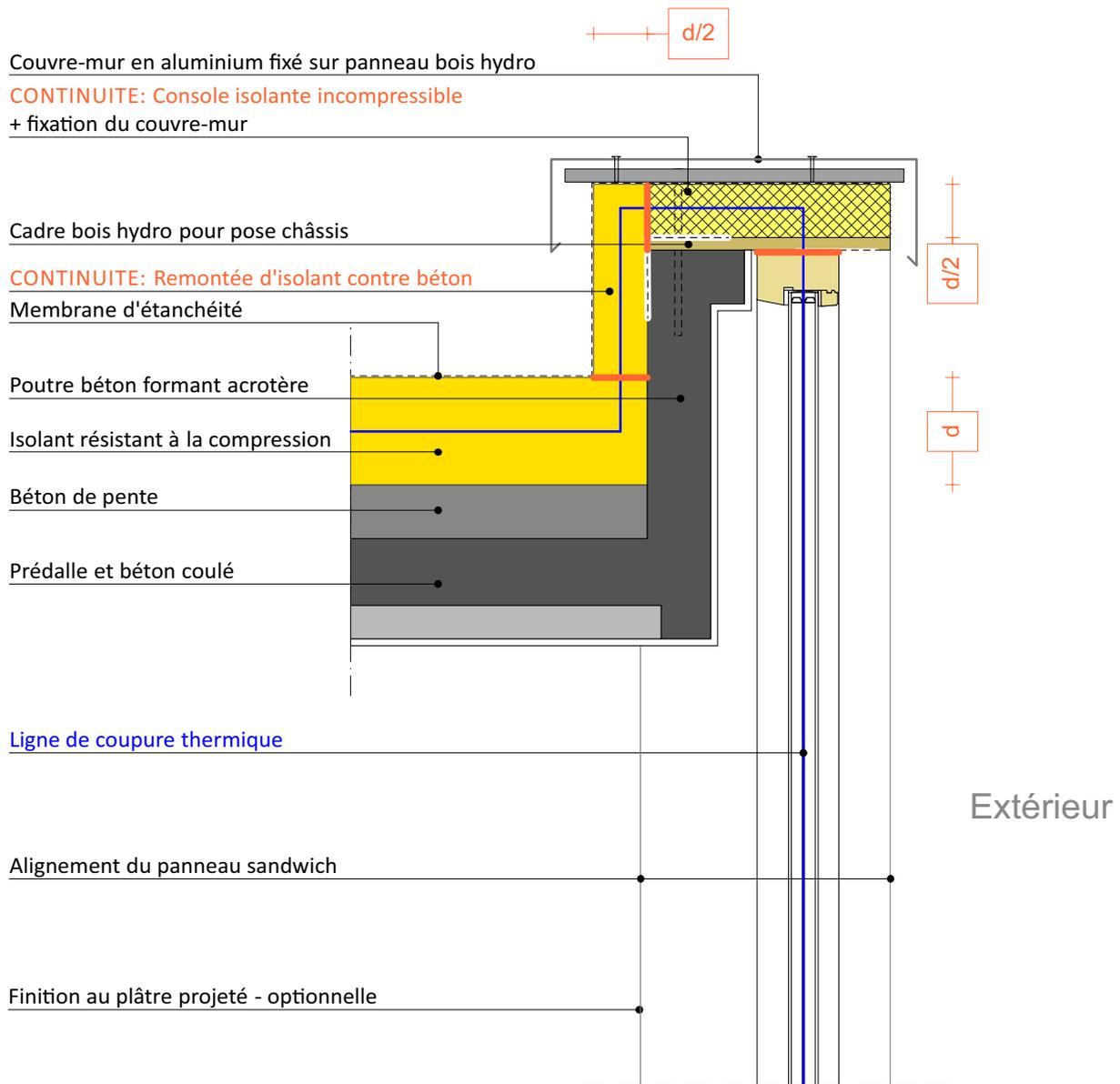
Ce détail présente une configuration de plus en plus rencontrée et qui nécessite un soin important. La continuité de l'isolation est d'autant plus importante que la zone de paroi la plus froide sera peu accessible. L'étanchéité à l'air sera réalisée par l'extérieur: châssis/panneau bois et remontée béton/panneau bois. Les pare-closes seront posées par l'extérieur, facilitant le remplacement du vitrage.
