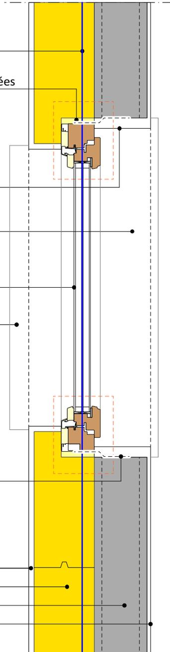
La pose du châssis dans la continuité de l'isolant sera optimale lorsqu'il est axé à mi-épaisseur de celui-ci. Ce type de pose nécessite une fixation adaptée étant donné le poids des châssis, notamment en triple vitrage. Le châssis sera préférentiellement posé dans un cadre, lui-même recevant l'étanchéité à l'air. Dans ce cas précis, elle sera plus facilement réalisée par l'extérieur via une bavette soudée.
