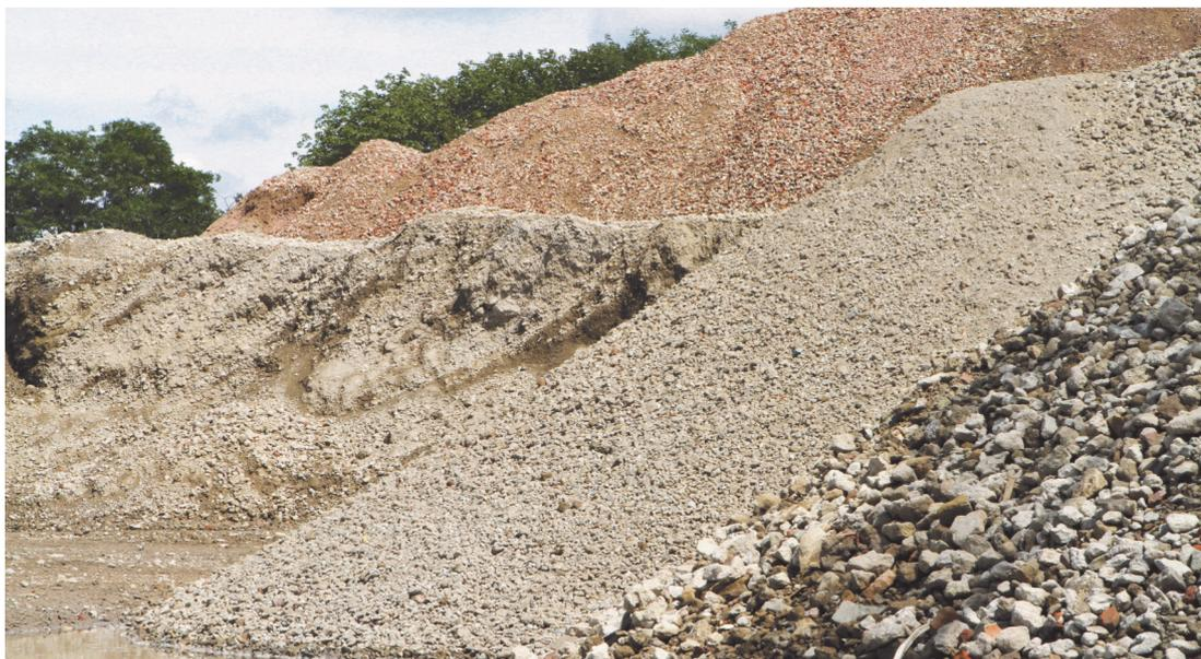
*L'exposition à l'air des granulats de béton recyclé favorise l'absorption de CO<sub>2</sub>*
