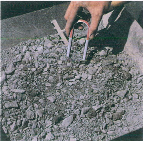
Bepaling van het werkelijke vezelgehalte in het droge beton.
