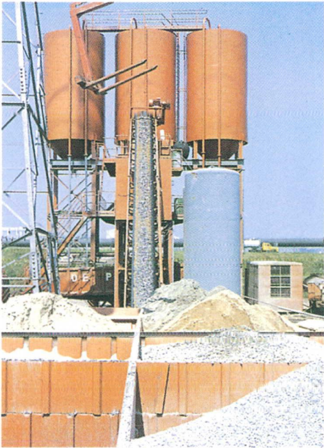
De staalvezels worden op de transportband gelijkmatig op het zand en de steenslag uitgestrooid.
