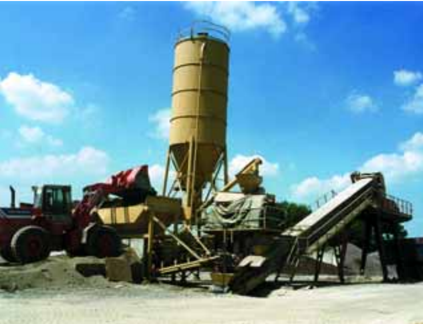
Fabricage van een homogeen zand-cementmengsel in een centrale.
