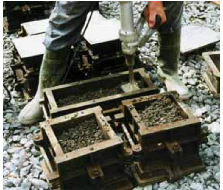
Fabricage van monsters voor de kwaliteitscontrole van het schraal beton. Verdichten gebeurt in twee lagen met behulp van een elektrische hamer.
