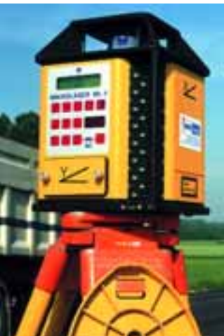
Het regelen van dwars- en lengteprofiel gebeurt met een laser. De vlakheid van het oppervlak wordt gecontroleerd met een rij van 3 m.
