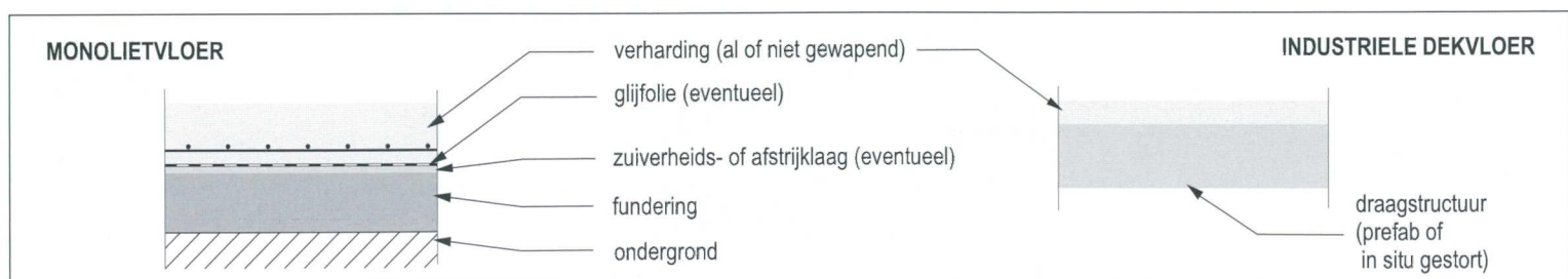
Fig. 1: Soorten cementgebonden bedrijfsvloeren
