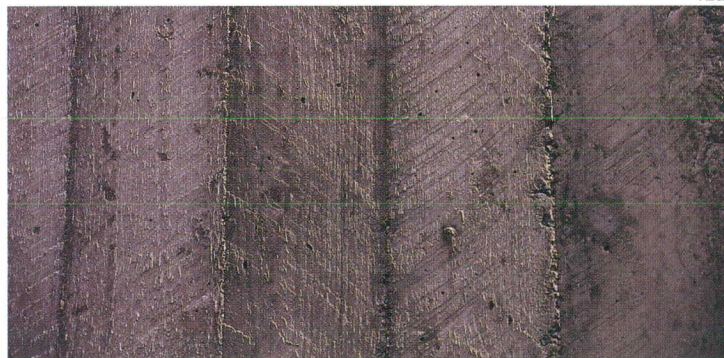
12. Invloed van contactbekisting. 12a. Ruw, mat oppervlak (gebruikte contactbekisting: planken). 12b. Glad, glanzend oppervlak (gebruikte contactbekisting: staal).
