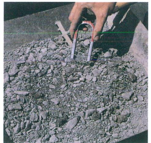
Détermination de la teneur réelle en fibres d'acier du béton sec.
