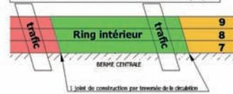
Fig. 11 - Mise en œuvre par phases : aperçu des phases successives de bétonnage dans la première (2004) et deuxième (2005) période
