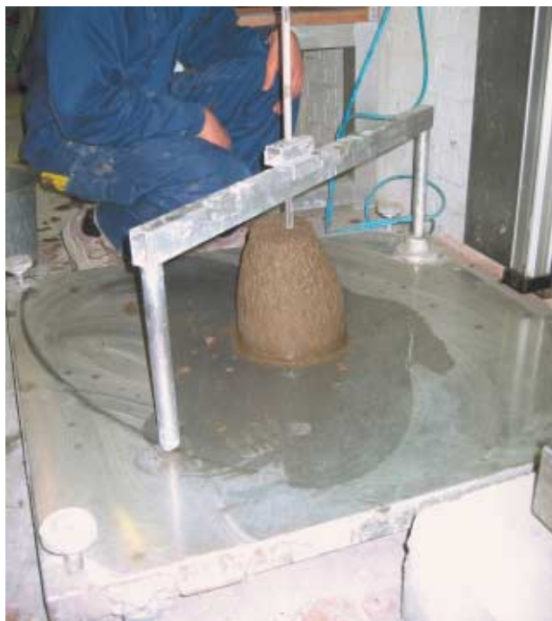
Détermination de l'affaissement ( slump )
