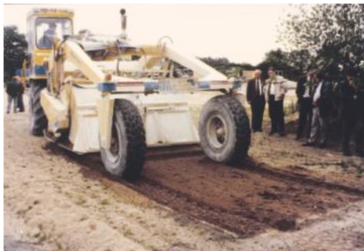
Les pulvérisateurs-mélangeurs sont principalement utilisés pour la stabilisation des sols.
