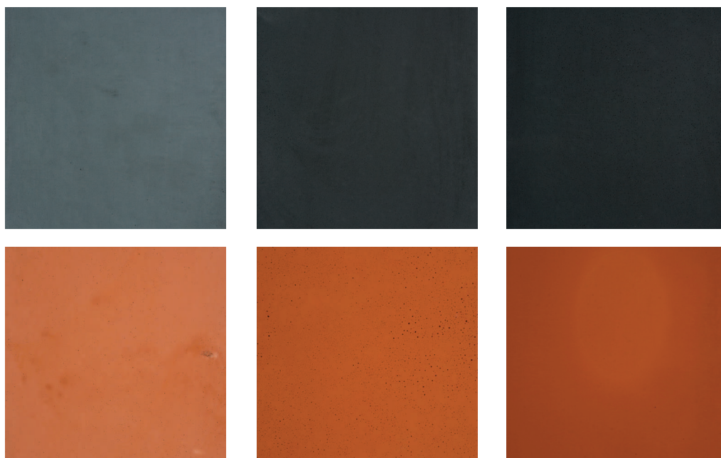
Invloed van de dosering op de kleur van beton (met wit CEM I, zwarte en rode pigmenten Scholtz, gewassen zand, W/C= 0,45) Links : 2 % Midden : 6 % - Rechts : 10 % (Foto : Betoniek 16/12)
