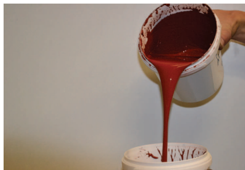
Pigmenten in vloeibare vorm (slurry) en in wateroplosbaar zakje (Foto's : Bart Helincks, Cathay)
