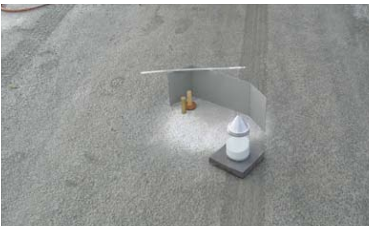
Uitvoeren van de zandvlekproef op de bouwplaats
