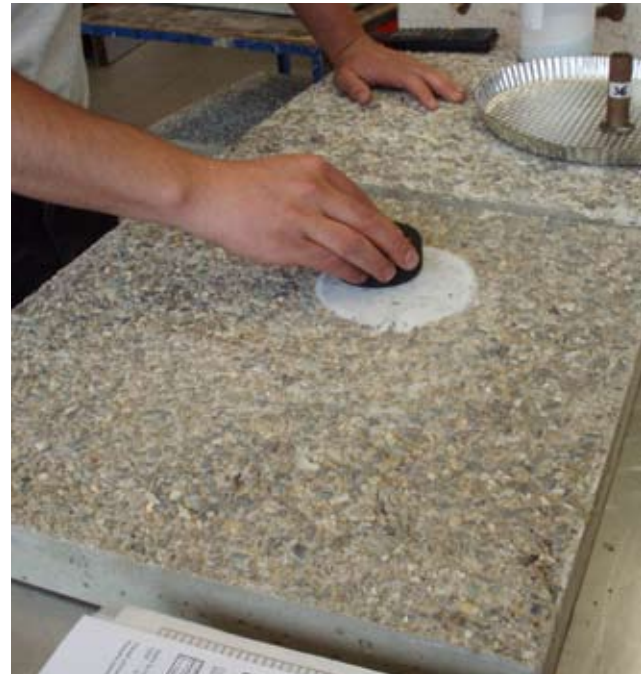
Uitvoeren van de zandvlekproef op een proefplaat
