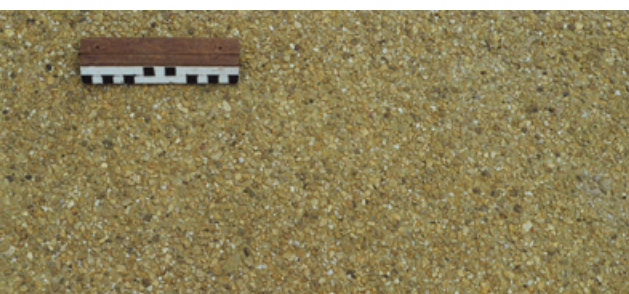
Het resultaat van het uitgewassen oppervlak, textuurdiepte ca. 1mm, met fijne gele steentjes en okerleurige mortel
