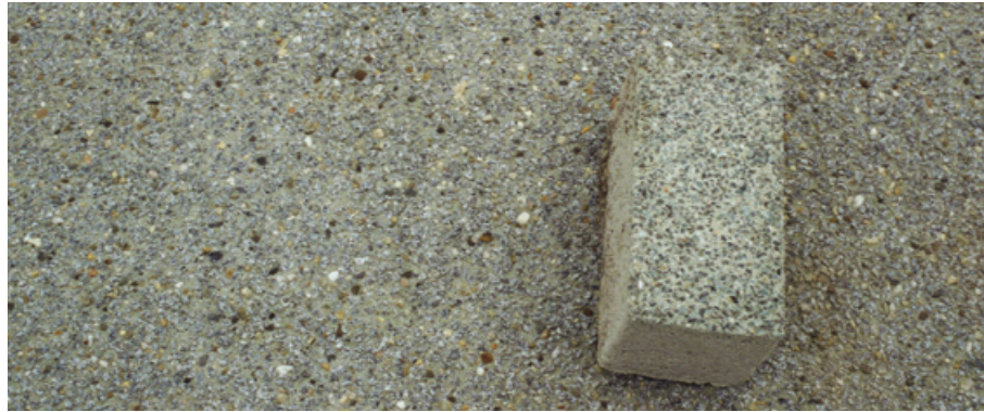
Resultaat van het groen uitgewassen oppervlak, vergeleken met een betonstraatsteen met gelijkaardig groen oppervlak
