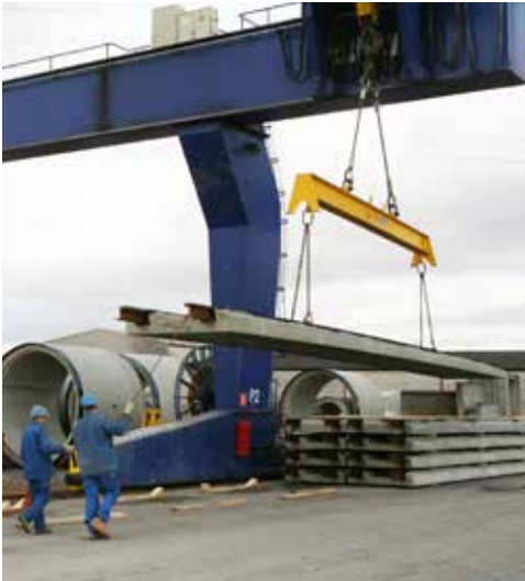
Geprefabriceerde plaat met ingebedde rails (Foto : www.socsa.be )
