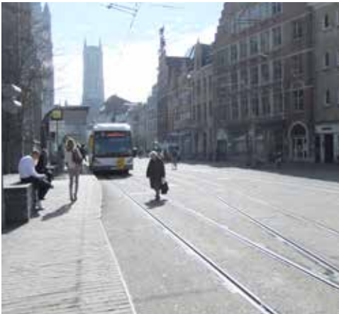
Gent, Korenmarkt – Uitgewassen beton op basis van witte kwarts en zandsteen, in harmonie met naastliggende natuursteen kasseien
