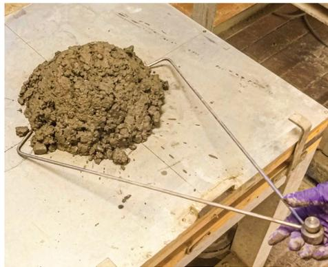
Mesure du diamètre de l'étalement
