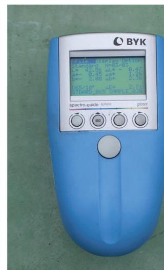
Exemple de spectrophotomètre
