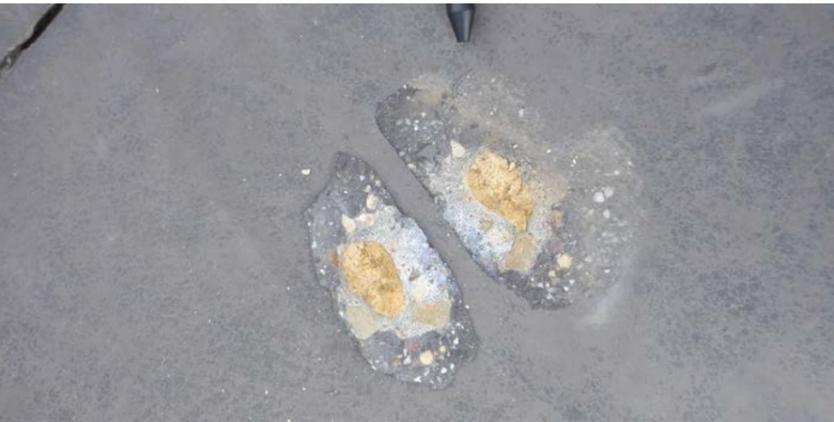
Lorsqu'un granulat poreux et saturé en eau gèle, il s'y développe des pressions hydrauliques internes qui peuvent le fissurer. Le gel des granulats dans un béton se manifeste avec plus d'intensité en surface : il se traduit par des éclatements locaux et par la formation de petits cratères (pop-outs).
