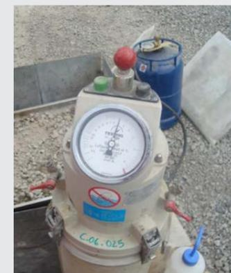
Il est essentiel de vérifier la teneur en air entraîné du béton. Sur béton frais, cette mesure peut se faire par la méthode pressiométrique en conformité avec la norme NBN EN 12350-7.
