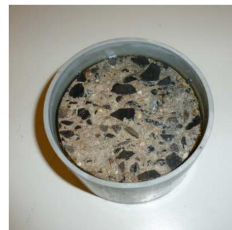
Eprouvette après 30 cycles de gel-dégel (ISO-DIS 4846.2)
