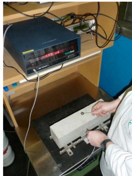
Mesure de la vitesse de propagation des ultrasons sur une éprouvette prismatique.
