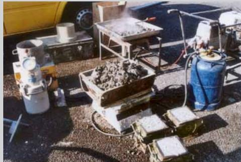
Contrôle du béton frais sur chantier avec à l'arrière-plan, le séchage du béton pour en déterminer la teneur en eau.
