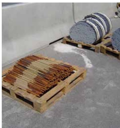
Barres d'ancrage avec partie centrale protégée et goujons avec revêtement synthétique
