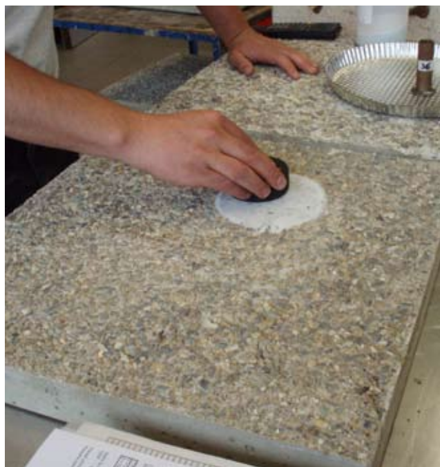
Réalisation de l'essai à la tache de sable sur une planche d'essai
