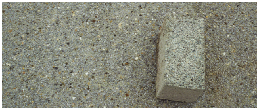
Résultat du revêtement de béton vert dénudé, par rapport à un pavé de béton vert similaire.
