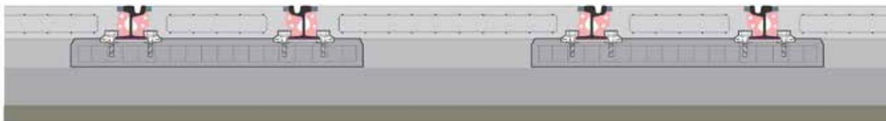
Coupe transversale d'une voie de tram en dalles de béton à traverses intégrées. Le revêtement de chaussée est constitué de dalles courtes avec double armature.
