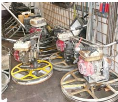
Poutres vibrantes et 'hélicoptères' de différentes tailles
