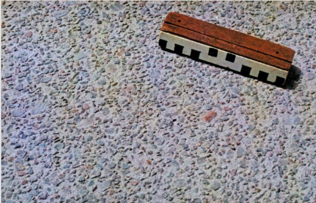
Zodra het beton onderaan verhard is, wordt het met vertrager behandelde oppervlak geborsteld en ontstaat een reliëf met een diepte van 1 mm dat gevormd wordt door de granulaten.
