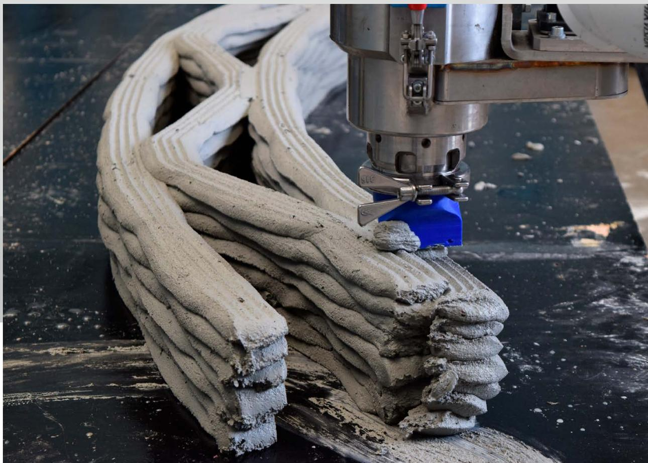
L'imprimante compose des murs porteurs creux dont la résistance est égale à un mur structurel en maçonnerie de béton traditionnelle. Ce profil en « treillis » est rendu possible par la liberté de création et de réalisation de l'impression 3D.
