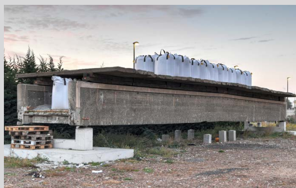
La passerelle totalement chargée, soit à environ cinq fois sa charge de service utile.
