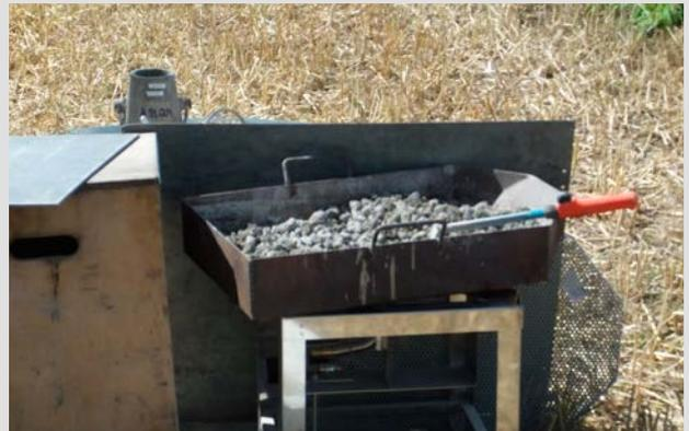
Réalisation d'essais sur béton frais (mesure de l'affaissement, teneur en air, teneur en eau par brûlage) par le personnel du CRIC-OCCN (Centre de recherche de l'Industrie cimentière)
