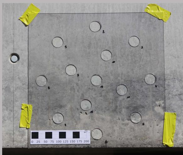
(1) Le résultat est dû entre autres à la manière dont l'essai est exécuté. Cette méthode d'évaluation détermine la teinte moyenne sur une surface de 500 mm sur 500 mm d'un pan de mur. A l'aide d'un colorimètre, on mesure sur cette surface la valeur en treize points de mesure fixés par le modèle de référence de la norme. La valeur moyenne de ces treize points de mesure est ensuite comparée à celle d'un autre pan de mur où la même méthode est appliquée.
