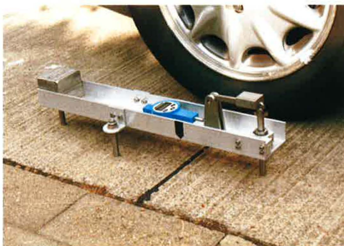
Fig. 25 - Mesure du battement de dalles au faultimètre
