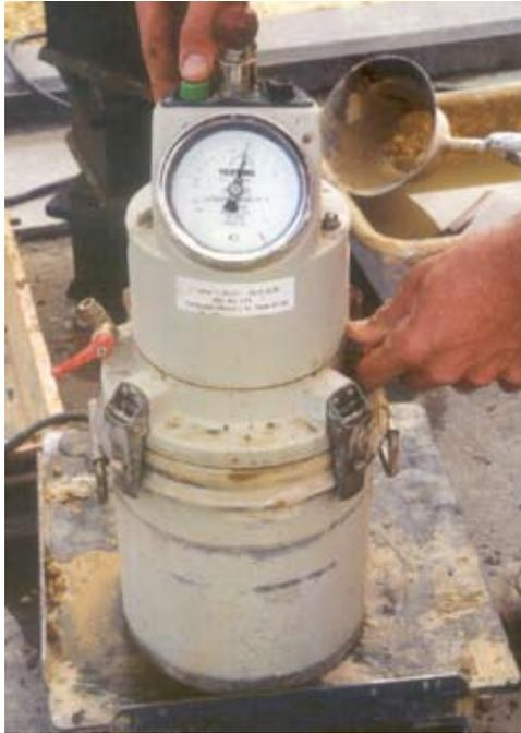
Figure 6 - Contrôle de la teneur en air d'un béton routier à l'aide d'un air-meter (méthode à pression variable selon NBN EN 12350-7)
