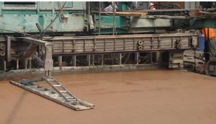
Figure 21 - Super-smoother : il s'agit d'une poutre lisseuse longitudinale à déplacement transversal à l'arrière de la machine
