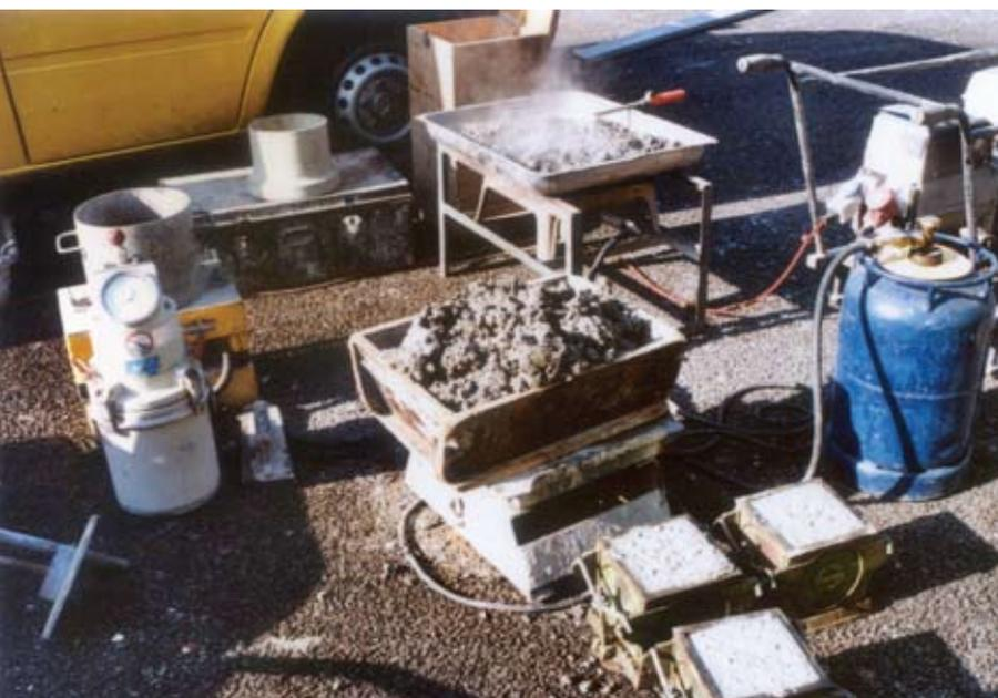
Figure 2 - Essais sur béton frais (à l'arrière plan, détermination de la teneur en eau par brûlage)
