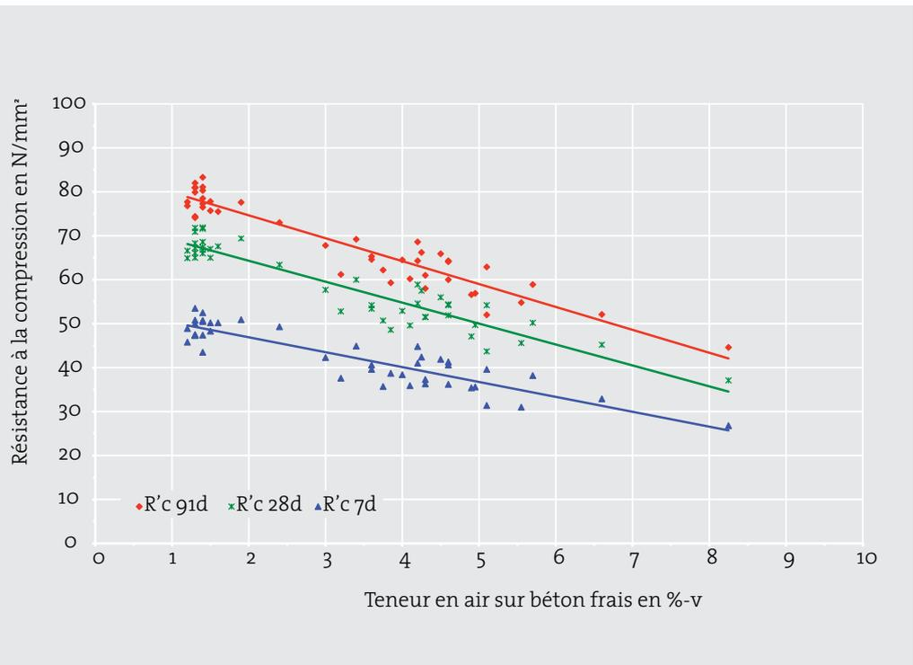
Figure 7 - Résistance à la compression en fonction de la teneur en air du béton (Bétons à base de 375 kg/m<sup>3</sup> de ciment – E/C = 0,45)
