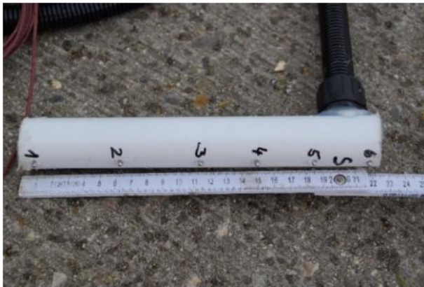
Bild 4: Temperaturmessfühler zur Messung in sechs Ebenen
