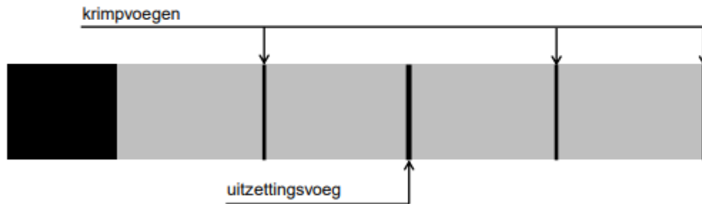
Figuur 6-1.3-1: overgang naar bitumineuze verharding (bovenaanzicht)
