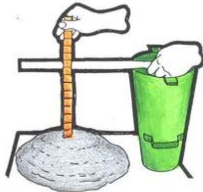
**Affaissement :** différence de hauteur entre hauteur initiale (300 mm) et béton affaissé
