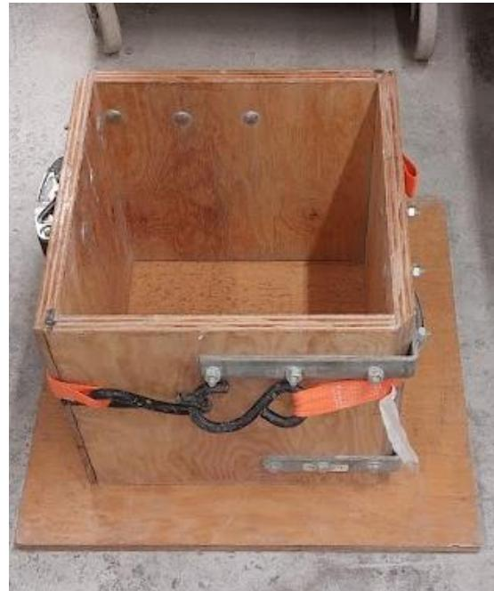
« Box test » pour évaluer si le mélange peut être mis en œuvre au slipform (AASHTO T 396)
