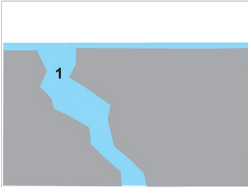
1- brede poriën (jong beton, beton van matige kwaliteit) verzadigd met water
