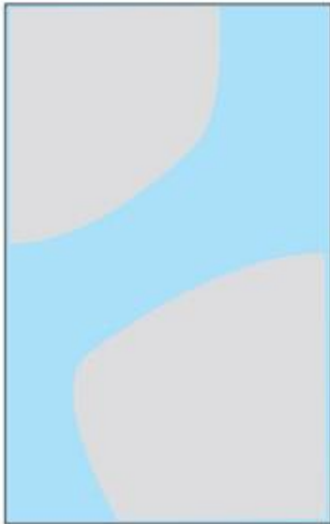
cementkorrels gescheiden door waterfilm
