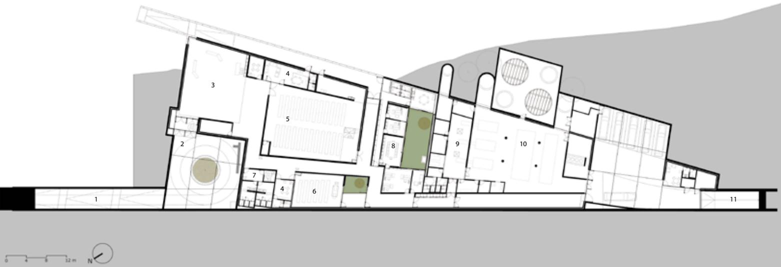
Deux rampes relient le niveau de la voirie au bâtiment enfoui dans le terrain. Elles guident le visiteur vers l'entrée, entre des voiles en béton apparent « protecteurs ».
