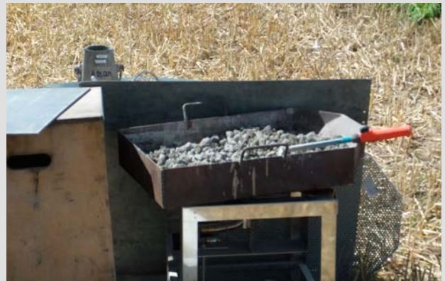
Uitvoeren van proeven op vers beton (zetmaat, luchtgehalte, watergehalte door droogbranding) door personeel van OCCN-CRIC (Onderzoekscentrum voor de Cementnijverheid)
