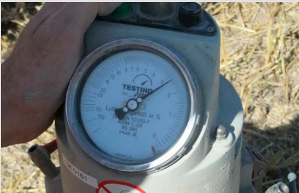
Uitvoeren van proeven op vers beton (zetmaat, luchtgehalte, watergehalte door droogbranding) door personeel van OCCN-CRIC (Onderzoekscentrum voor de Cementnijverheid)
