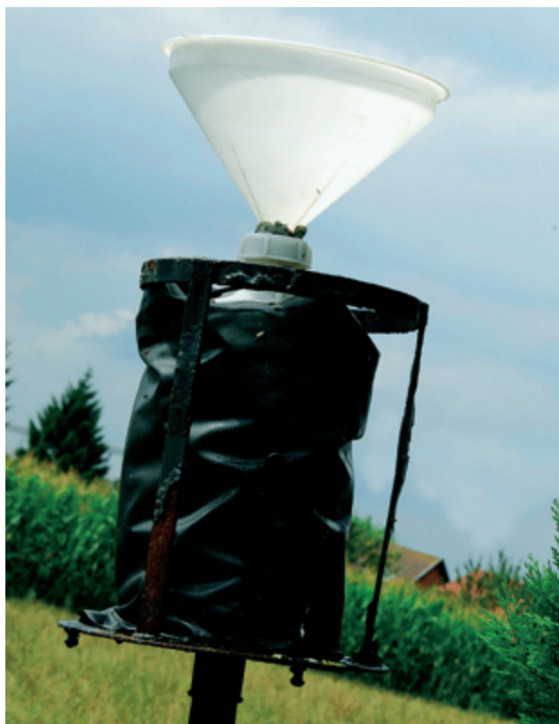
Het OWEN-meettoestel, geïnstalleerd in de omgeving van de cementbedrijven.
