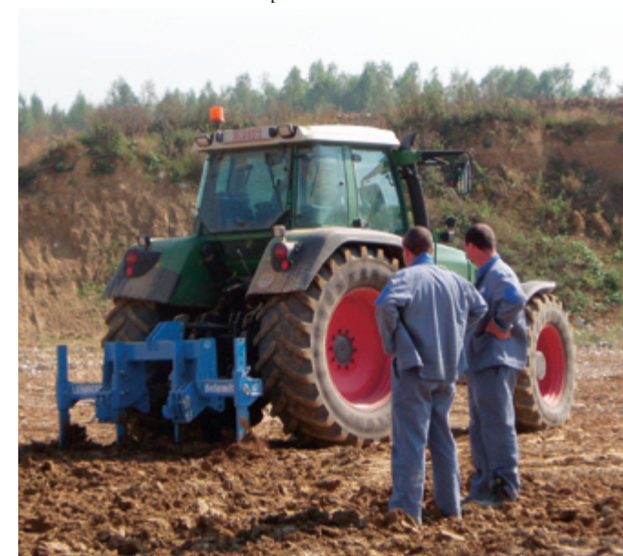
Agrarische herinrichting van de groeve te Romont (CBR) : het losbreken van aarde met een landbouwvoertuig.
