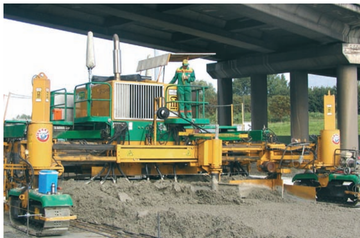
Glijbekistingsmachine in actie met een werkingsbreedte van 7 m
