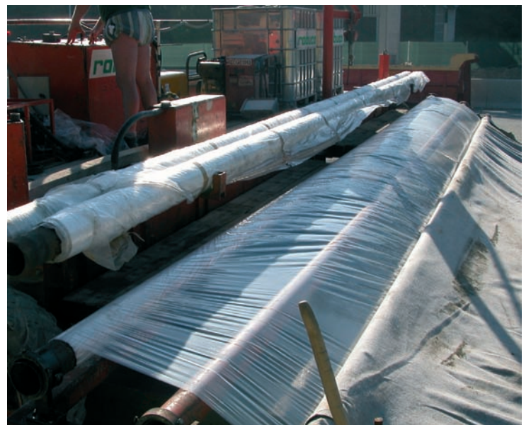
Bescherming van het oppervlak door afdichting met een plastic folie
