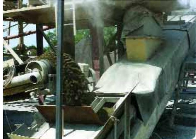
Fabrication d'un mélange homogène de sable ciment en centrale.
