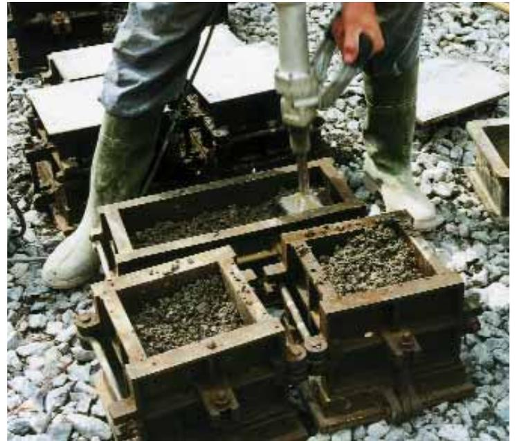
Fabrication d'éprouvettes pour contrôle de la qualité du béton maigre. Compactage en deux couches au marteau électrique.
