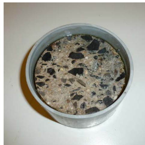
Eprouvette après 30 cycles de gel-dégel (ISO-DIS 4846.2)
