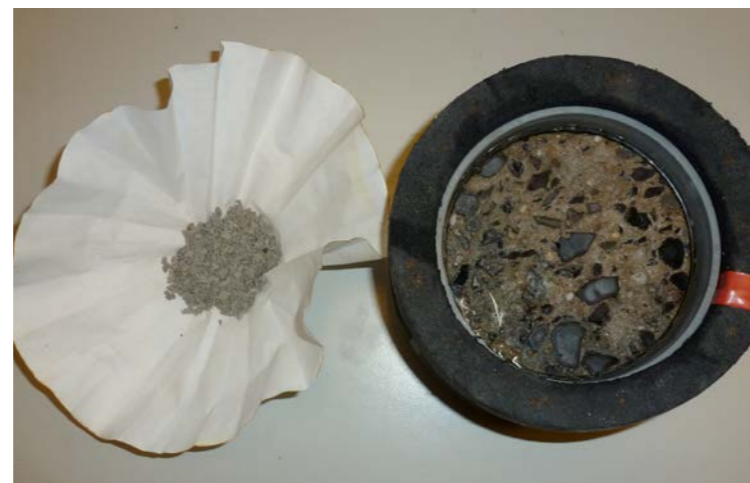
Eprouvette d'essai et pertes récupérées lors du Slab test (CEN/TS 12390-9)
