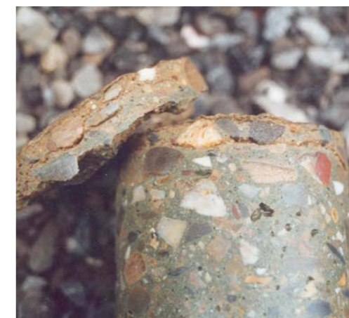
Voorbeelden van vers beton dat aan vorst werd blootgesteld: - straatgoot en boorkern genomen in het beton; het beton heeft niet langer een compacte structuur
