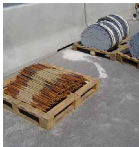
Ankerstaven met beschermd centraal gedeelte en deuvels met kunststofbekleding
