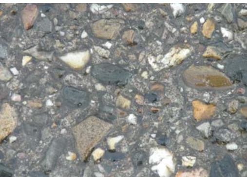
Grof uitgewassen beton 0/40 of 0/32, boven op basis van porfiersteenslag, onder op basis van gebroken grind
