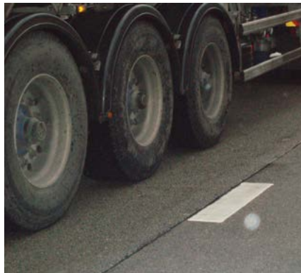
Het soort voertuig, de snelheid en de interactie band-wegdek zijn belangrijke factoren m.b.t. lawaaiproductie
