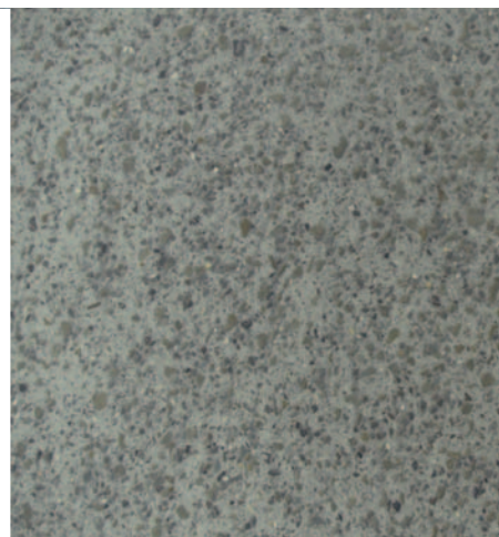
Na het zagen wordt de cementmelk van het betonoppervlak met water weggeborsteld. Zo ontstaat een uitgewassen oppervlak met heel goede eigenschappen van stroefheid en rolgeluid. Dankzij de kwaliteitsvolle samenstelling van wegenbeton kan de busbaan al vier tot zeven dagen na aanleg in dienst worden gesteld, namelijk zodra de drukweerstand op boorkernen gemiddeld 40 MPa bedraagt.
