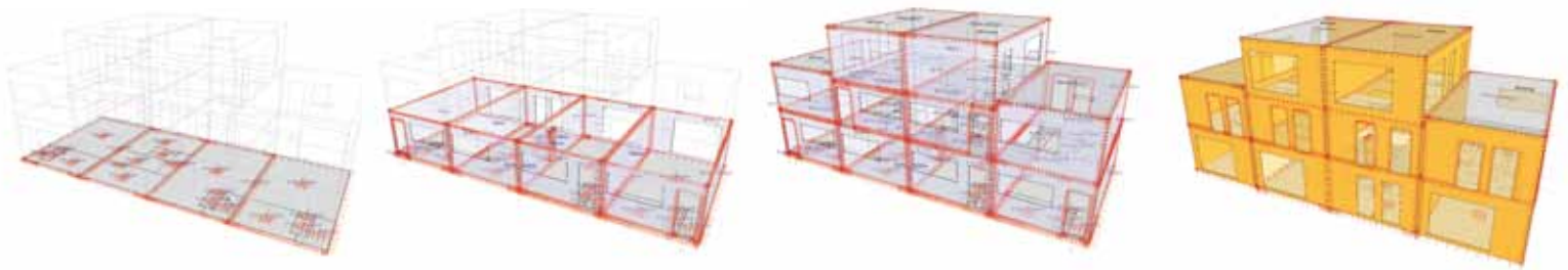
Simulatie van de elementen en montagefase van de geprefabriceerde betonnen elementen met het resultaat van de vervorming in uiterste grenstoestand.
