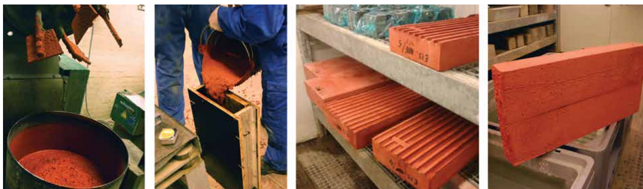
Laboproeven op tint, oppervlak en textuur van het beton
