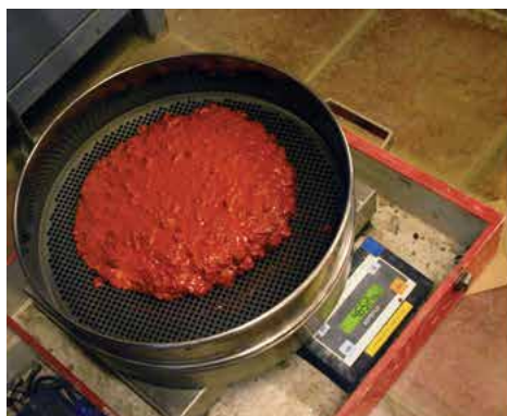
Laboproeven op zelfverdichtend beton
