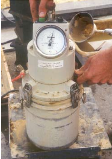
Figuur 6 – Controle van het luchtgehalte met behulp van een aërometer (drukmethode volgens NBN EN 12350-7)
