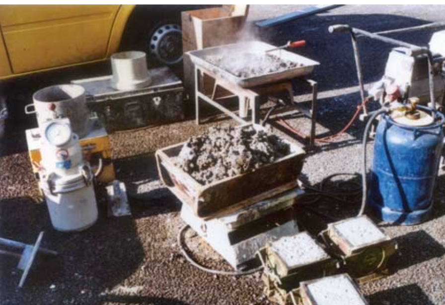
Figuur 2 – Controle van het verse beton. Op de achtergrond : beton wordt gedroogd met het oog op het bepalen van het watergehalte
